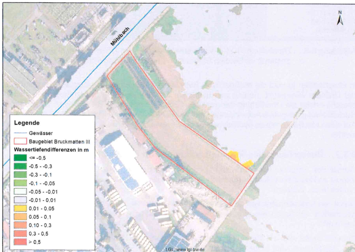
Abbildung 6-2: Darstellung HQ100-Wasserspiegeldifferenzen (Plan- minus aktualisierter Istzustand) im Bereich Bruckmatten III
